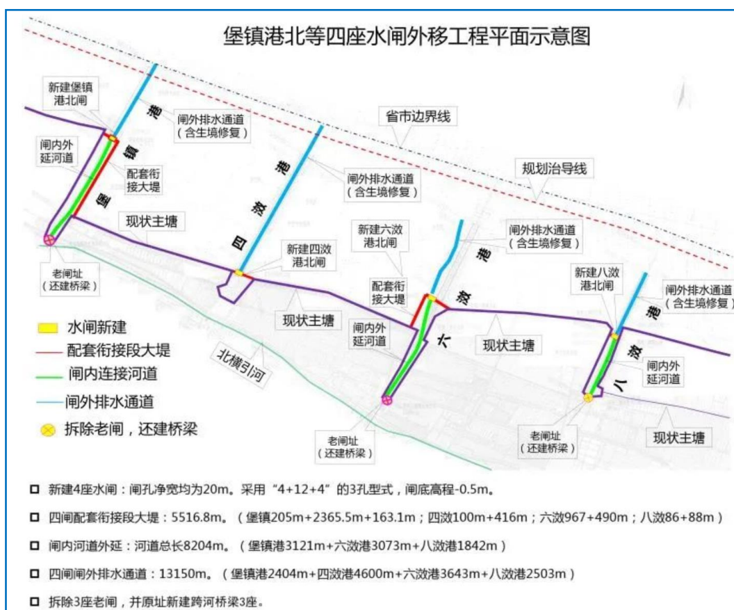
图 7.2-8 北四闸外移工程总体平面布置图
