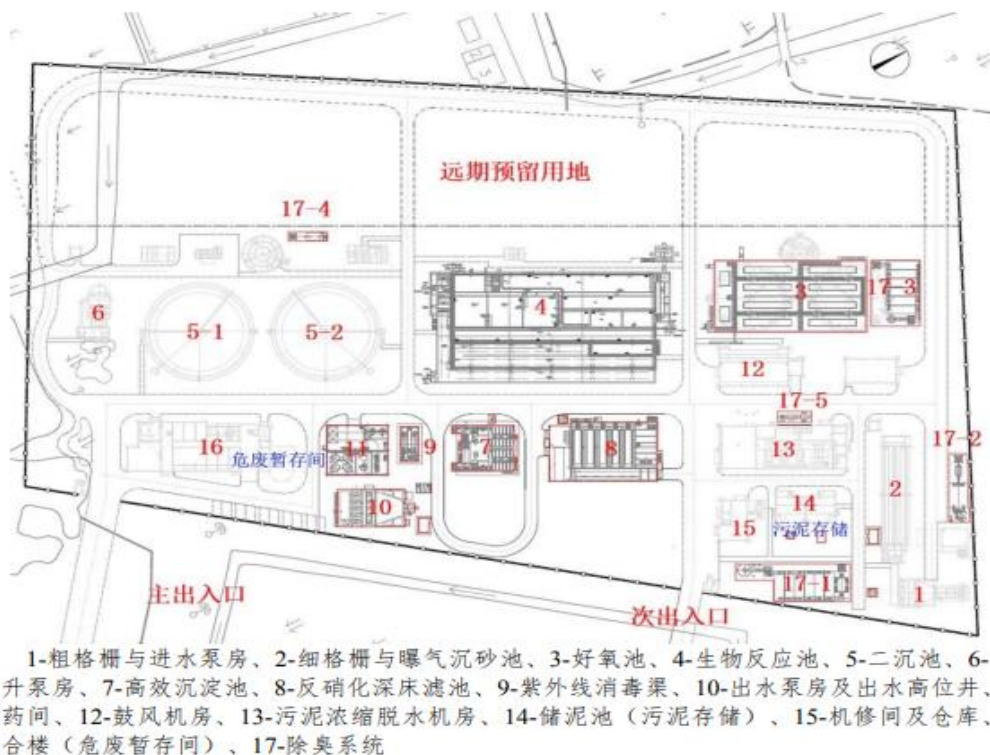
图 3.1-2 提标改造后厂区平面布置图
