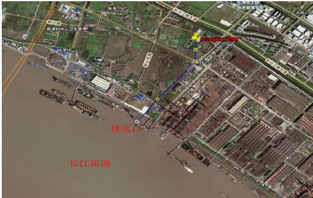
图 3.1-23 尾水排放管线布设
