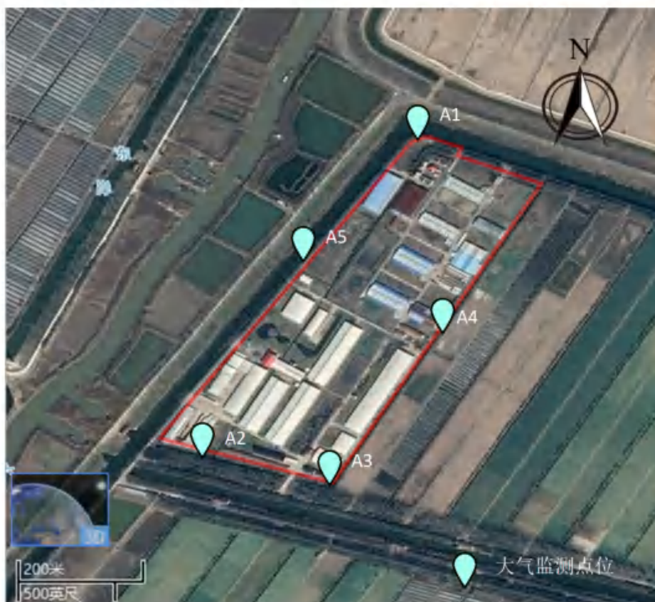
图3.2-1 厂界废气监测布点示意图
