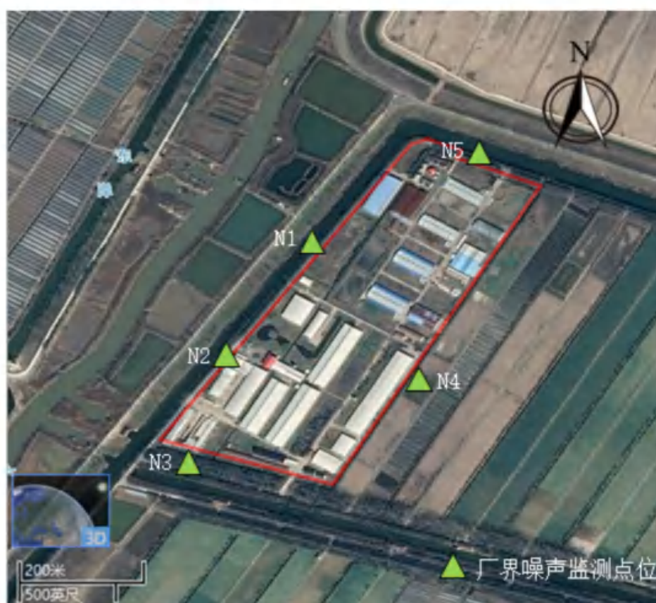
图 3.2-3 厂界噪声检测布点示意图
