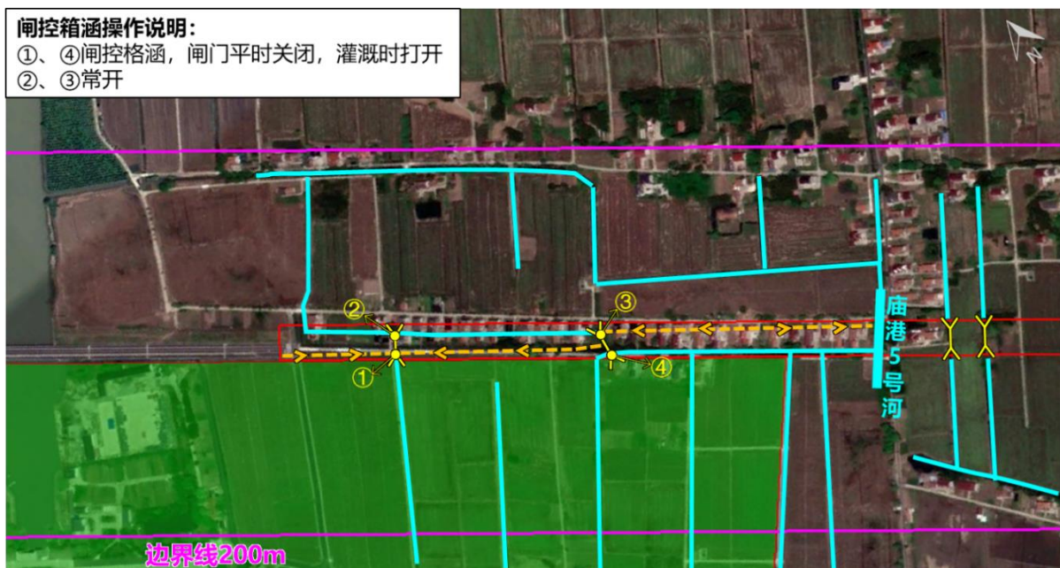
图 2.2-5 毗邻二级保护区路段排水沟局部放大图
