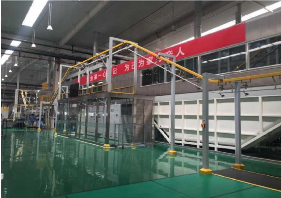
图 4-3 电泳线密闭示意图
