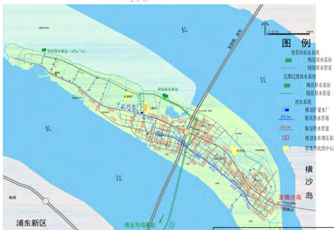
图 4-15 崇明区供水系统规划布局示意图
