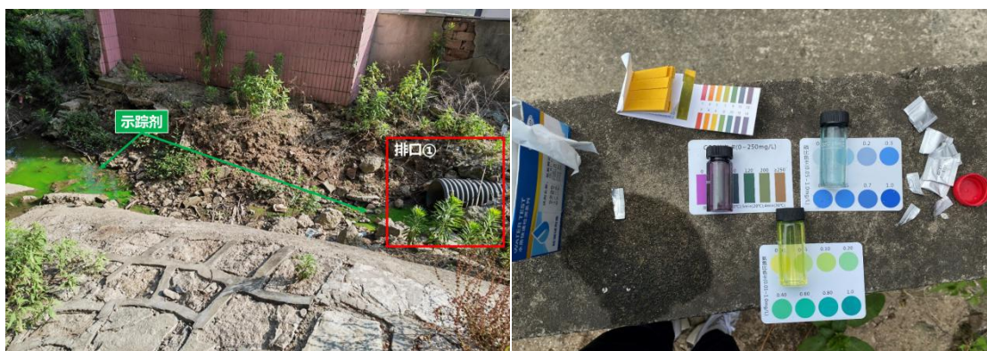
投放示踪剂（左）、现场快检水质情况（右）
