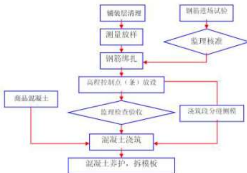
图 4.4-3 现浇结构施工工艺流程
