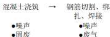
图 5.1-2 构件预制生产线工序及产污环节
