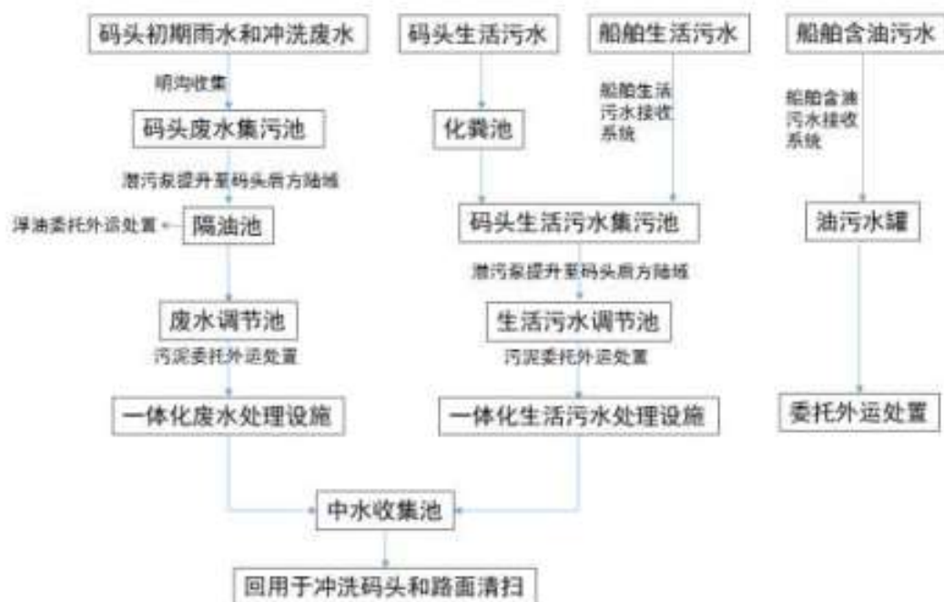
图 9.1-1 产业园建设期污水处理工艺流程图
