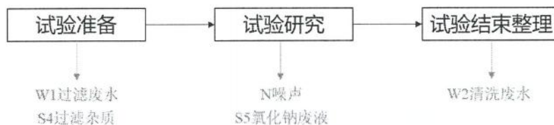
图 2-3 船用舱室智能设备联调与可靠性试验工艺流程及产污环节
