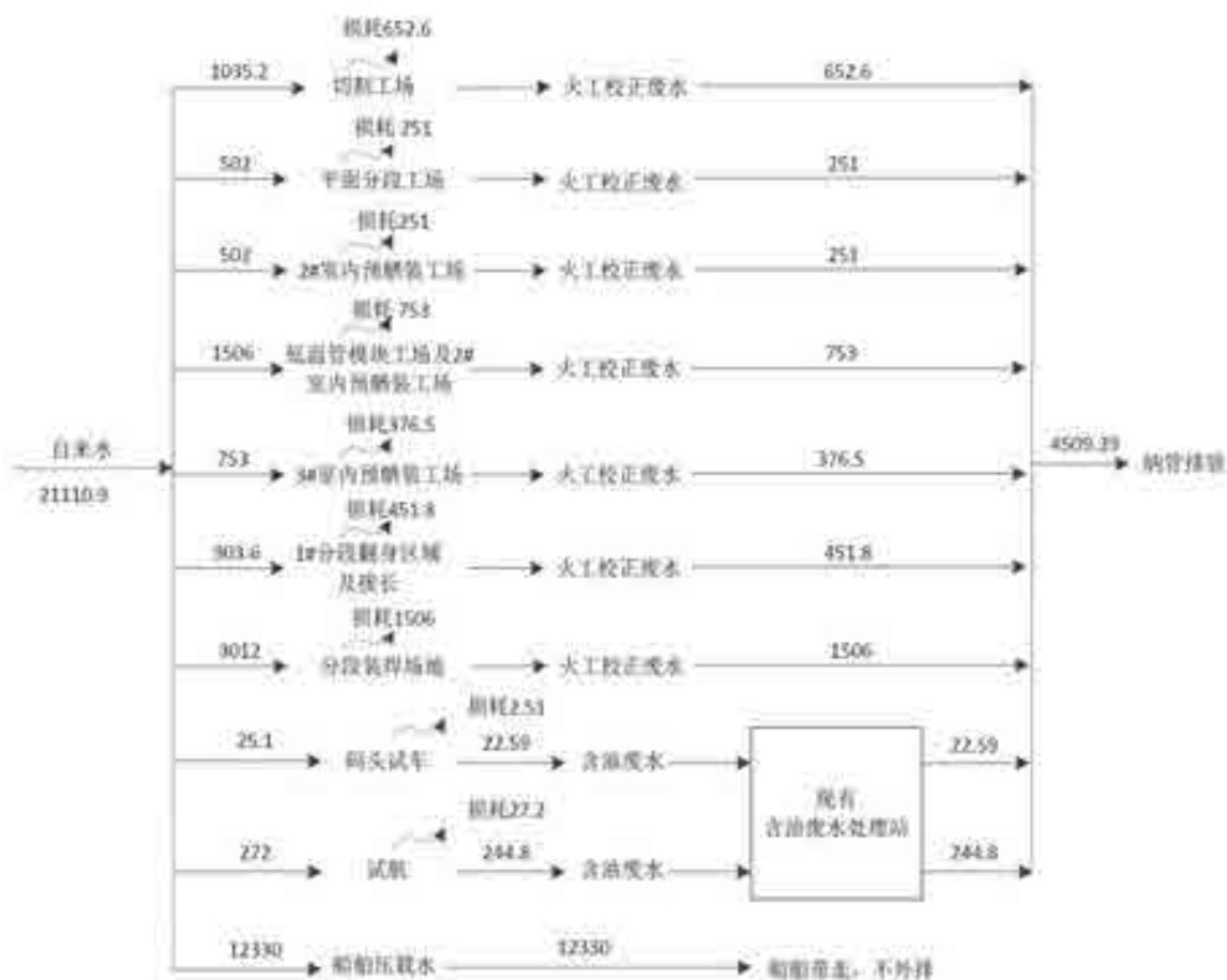
图 4.3-1 本项目水平衡图 (单位: t/a)
