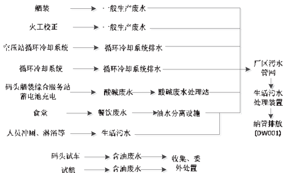
图 2.3-1 生产一区废水收集、处理系统图
