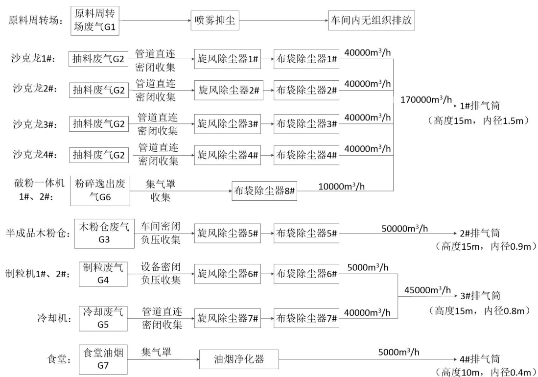
图 4-1 本项目废气产生、收集及处理系统图
