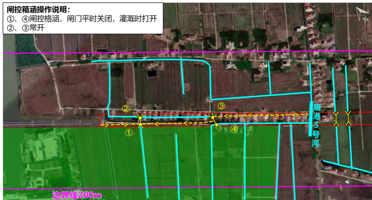
图 5.5-3 毗邻二级保护区路段排水沟局部放大图
